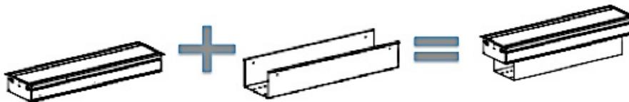
Für jede Grösse kann eine Stahlwanne für die Befestigung der Steckdose und der Unterbringung der Kabel montiert werden.
